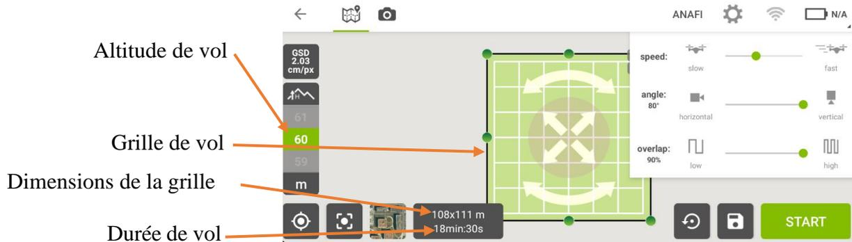
**Figure 6 :** Interface de l'application PIX4D Capture montrant les paramètres du vol de drone
