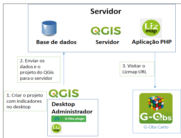
Figura 17. Fluxo geral de dados e informações no Sistema de Informação Territorial desenvolvido no UMR Tetis.
