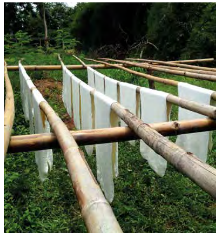
Après dilution et coagulation contrôlée du latex avec de l'acide formique, le coagulum est laminé. La feuille de caoutchouc naturel est séchée à l'air libre sur des bambous. Station de recherche de Kasetsart University, Thaïlande.
