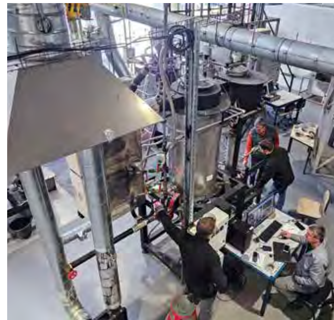
Conception et mise au point d'un réacteur de production d'énergie à partir de résidus agroalimentaires dans la halle Biomasse-énergie [Cirad Montpellier] © D. Josserond, Cirad
