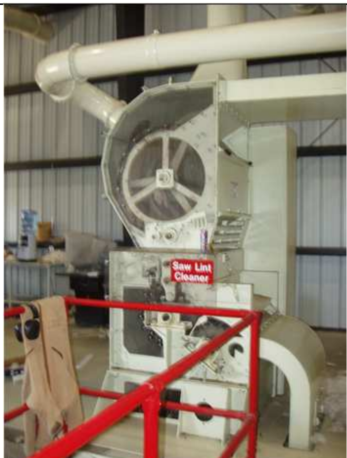
Le lint cleaner. Vue du nettoyeur dont barres de battage en acier plein (8 au total).
