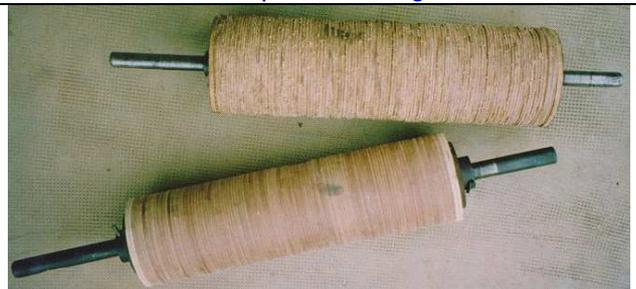
6. L'ensemble est placé sur une presse à rouleaux (10t ici en RC1), on complète au fur et à mesure de la descente avec des rondelles supplémentaires.
