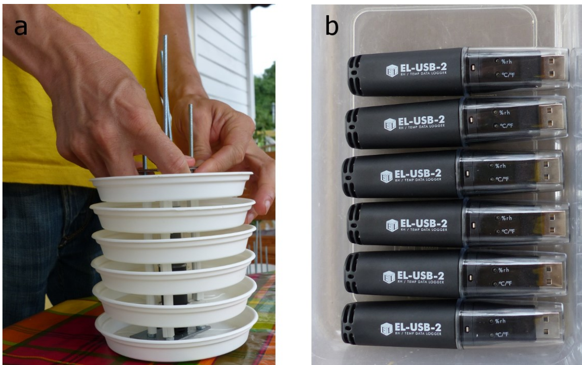
Figure 4 : Capteurs de température et d'humidité relative de l'air
