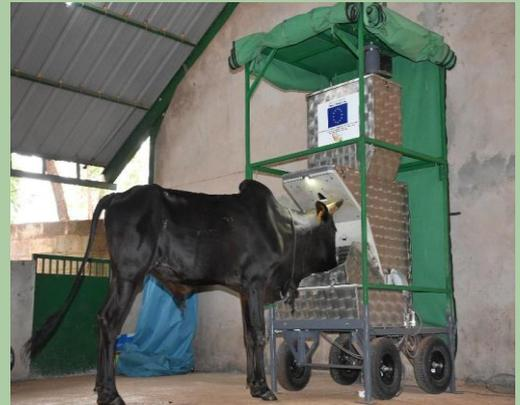
*Un taurillon pendant les mesures des émissions de méthane entérique (dispositif GreenFeed®). Plateforme expérimentale du CIRDES (Burkina Faso) installée par le projet CaSSECS pour des mesures directes de méthane entérique chez les bovins*
