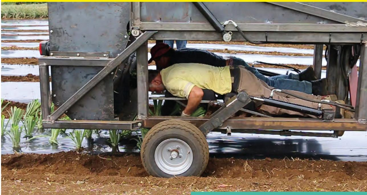
Les planteurs sont sous une trémie de distribution de rejets. Les planteurs, au nombre de deux, plantent les plants directement dans le plastique.
