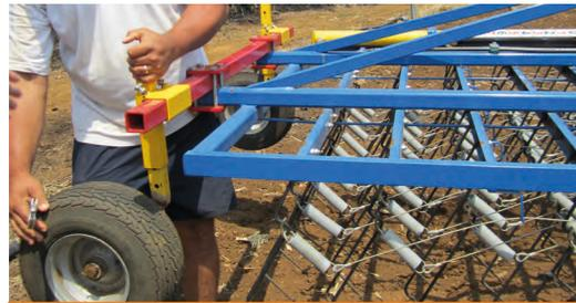
Réglage de la profondeur et dureté de la dent
