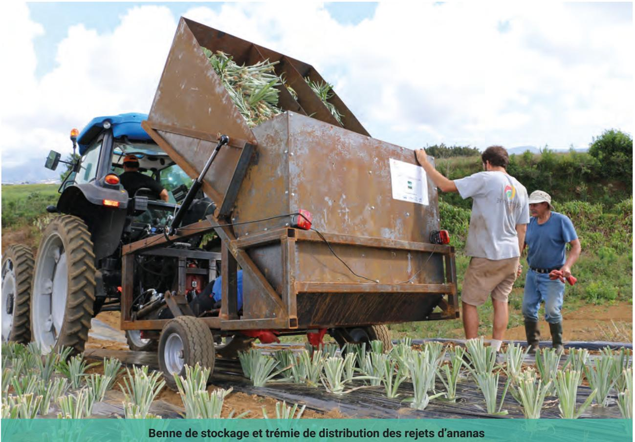
Benne de stockage et trémie de distribution des rejets d'ananas
