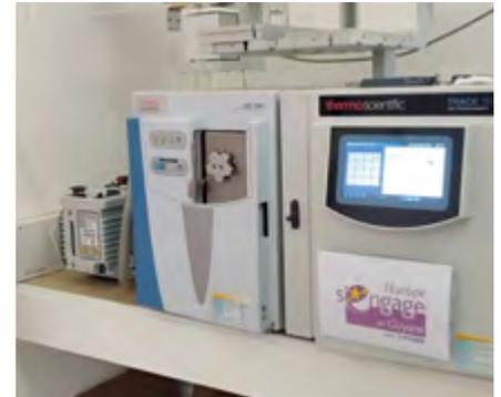
Le GC-MS Trace 1610-ISQ700 surmonté du passeur TriPlus RSH Smart © R. Lehnebach, Cirad
