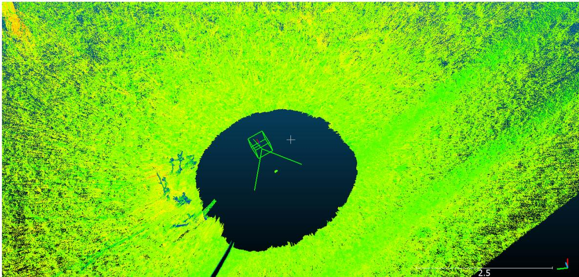
Figure 6: Vue du dessus des résultats d'un scan LiDAR. Chaque point est issu d'un tir laser intercepté par un objet et re-capté par le LiDAR. La zone sombre au centre de l'image correspond à la zone d'angle mort du scanner. Une zone équivalente se retrouve à la verticale au-dessus du LiDAR.
