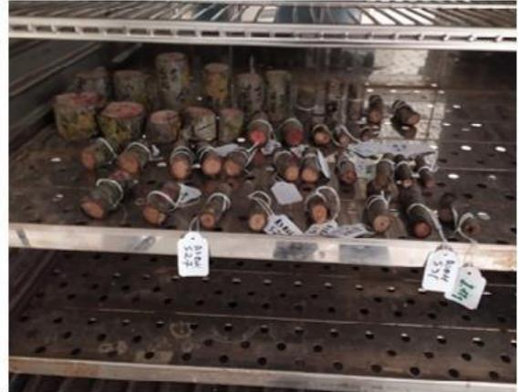
Figure 11: Calcul du volume grâce à la poussée d'Archimède, nous immergeons nos échantillons dans l'eau et le volume d'eau déplacé est indiqué par la balance en gramme, correspondant à des  $\text{cm}^3$ (A). Séchage des échantillons à l'étuve à  $100^\circ$  pendant au moins 4 jours
